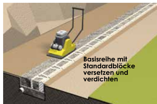
Basisreihe versetzen und verdichten.
