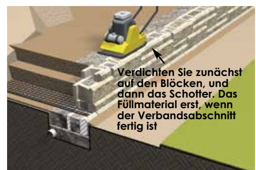
Verbandsabschnitt fertigstellen und verdichten.
